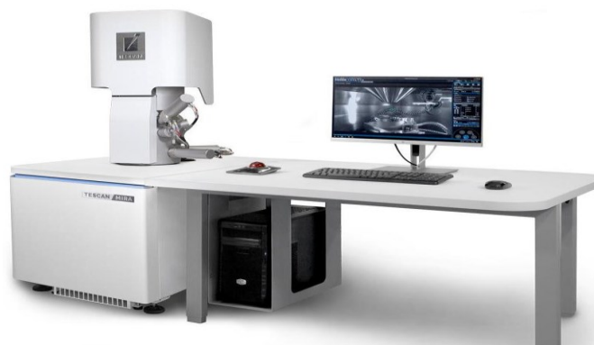
Рисунок 2.1 - Сканирующий электронный микроскоп TESCAN MIRA 3 LMU
